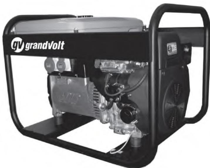
Компактные профессиональные бензиновые электростанции серии GVR на базе двигателей ROBIN-SUBARU (Япония) имеют мощность от 6 до 12.5 кВА. В серии представлены электростанции с топливными баками объемом от 7 до 35 л, ручным или электрозапуском (АКБ не входит в комплект поставки). Дополнительно можно приобрести транспортировочный комплект для удобства перемещения бензогенератора (см. «Дополнительное оборудование»)
